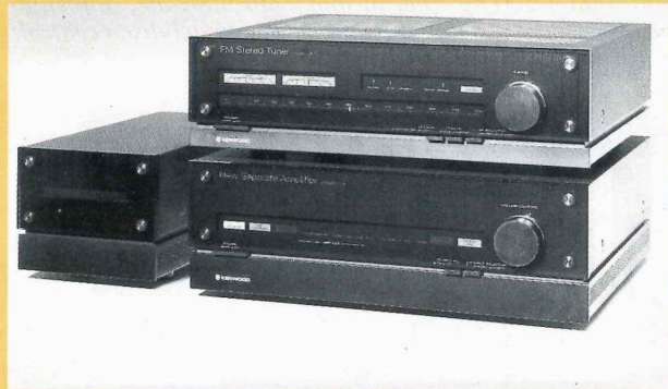
Il sinto con decoder a campionamento L-01T e l'integrato a due telai L-01A del '79, a struttura
